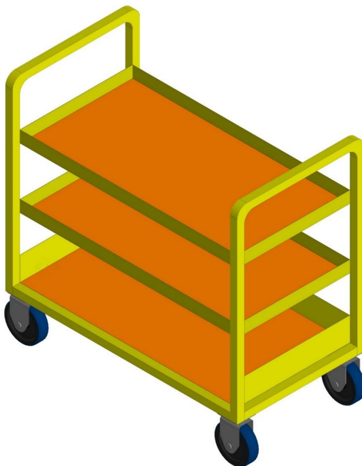
Сурет 3.10 – "Жинақтарды тасымалдау арбасының" CAD жүйесінде модель
